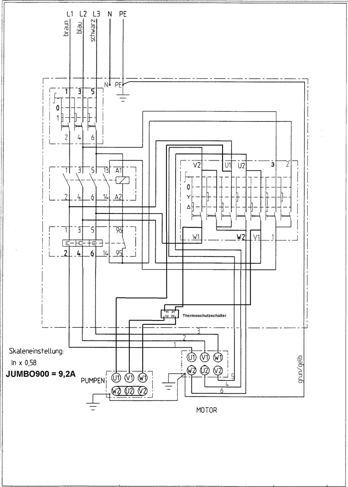
**Einspannung - Motor 400V mit einphasenpumpe (JUMBO 900 und 1000)**
