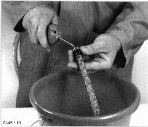
Blasen Sie den Ölfilter mit Druckluft von innen nach außen aus.
