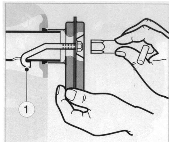
Setzen Sie das Auspuffsieb mit dem Bügel « 1 » in die Bohrung ein und ziehen Sie anschließend wieder nach außen, damit der Bügel nicht mehr aushaken kann. Ziehen Sie die Sechskantmutter fest.
