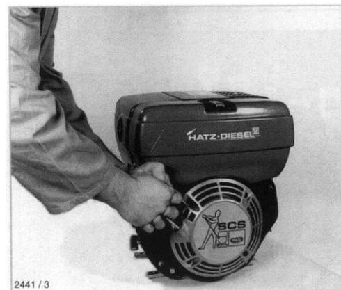
Ziehen Sie den Handgriff mit dem Seil langsam heraus, bis ein geringer Widerstand spürbar wird. Lassen Sie dann das Seil zurücklaufen, um im Startvorgang die gesamte Seillänge nutzen zu können.
