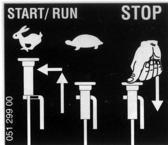
Stellen Sie die Drehzahlverstellung in die « START/RUN »- Position, in dem Sie den Knopf ziehen und klemmen. Verwenden Sie niemals Starthilfe-Sprays.
