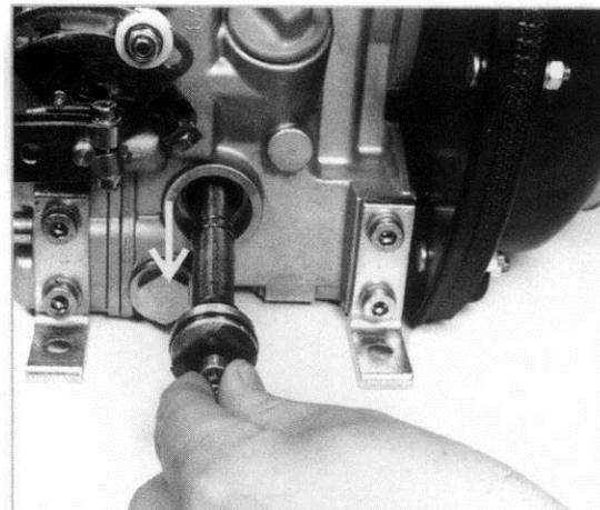
Ziehen den Ölfilter aus dem Gehäuse.
