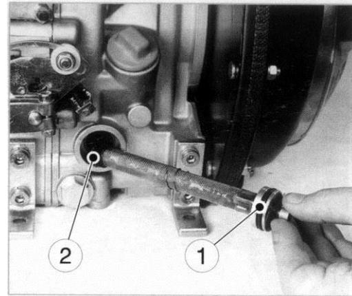
Prüfen Sie den Dichtring „1“ auf Beschädigung und ggf. erneuern Sie ihn. Prüfen Sie den Dichtring „2“ auf Beschädigung und fester Sitz und ggf. erneuern Sie den Ölfilter.
