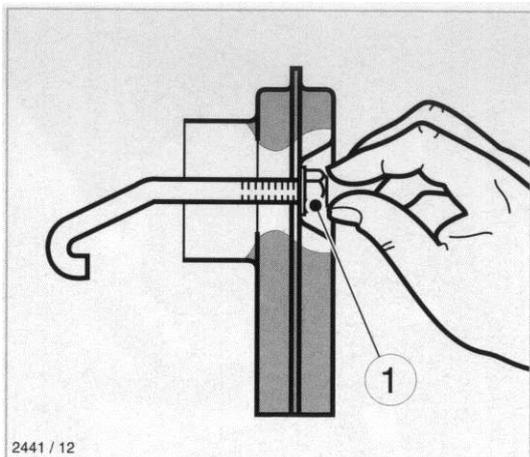
Schrauben Sie die Sechskantmutter « 1 » ca. einen Gewindegang an.
