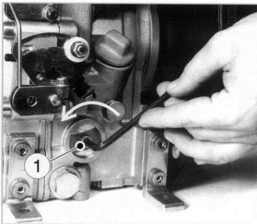
Lösen Sie die Schraube « 1 » ca. 5 Umdrehungen.
