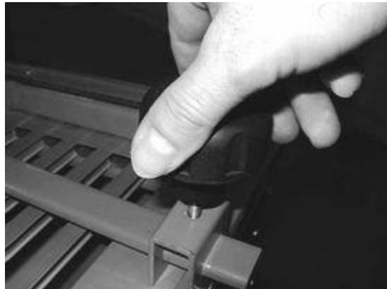
Die 2 Schenkel der Schnittführung in die Halter einschieben
